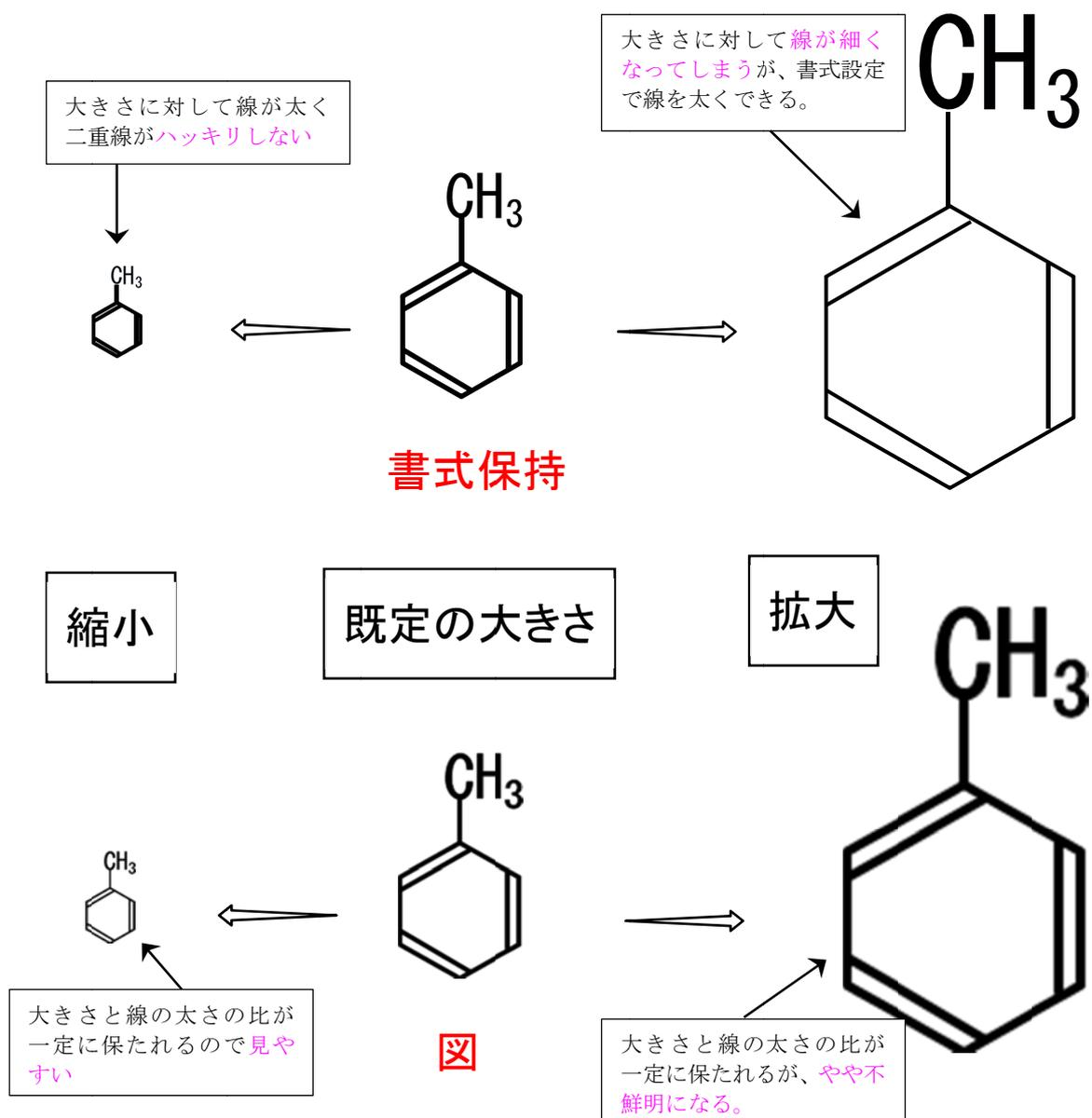
CH<sub>3</sub>など「ベジェ曲線の塗り」で描かれているデータは、拡大・縮小に対して威力を発揮しますが、太さを指定した「Line データ」は拡大・縮小しても太さが一定であるため、少し補正する必要があります。オススメは、拡大・縮小する場合は図で取り込み、拡大の場合に不鮮明感がある場合は、書式保持で太さを補正するのがよいと思います。(取り込んだ図形を加工・編集するばあいは書式保持です。)
